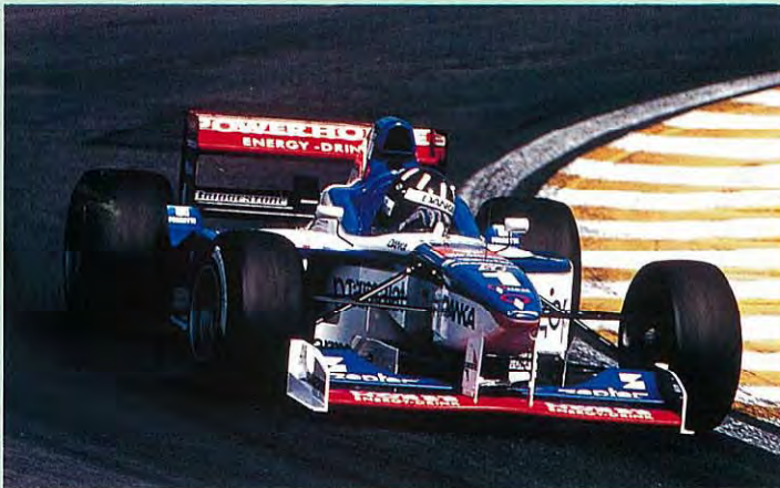
レース用タイヤは最高時速300km、タイヤ温度200℃に耐える。
