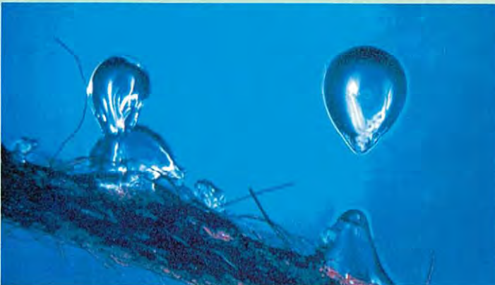
界面活性剤が汚れを包み込み、汚れを浮か上らせている（ローリングアップ現象）。
