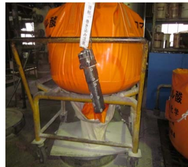
フレコン台車・架台
