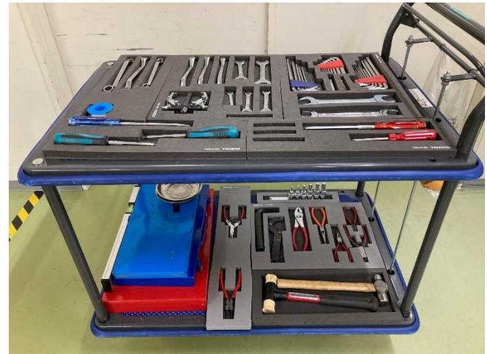
台車上で工具毎に置ける枠を作成
