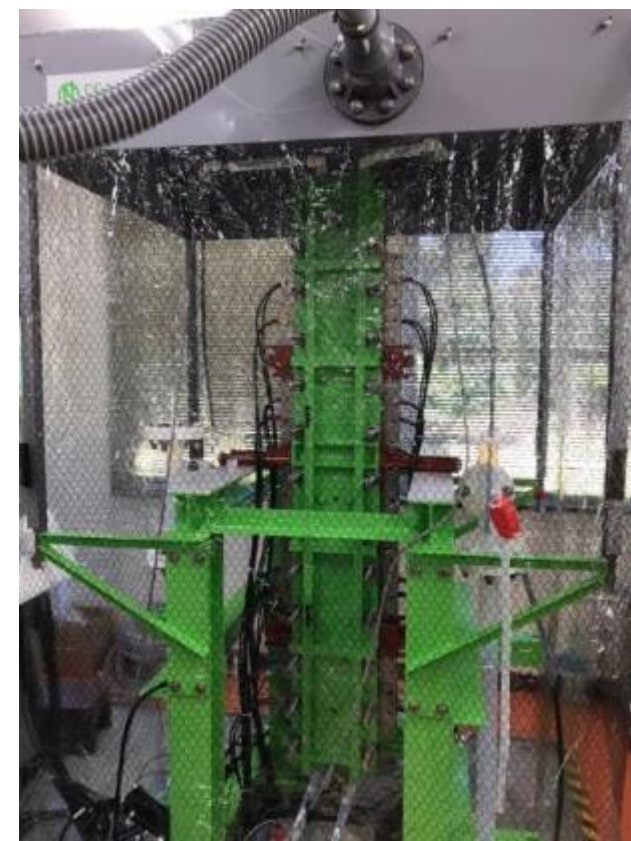
高さ合わせ電解槽
