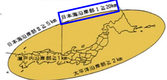
1) 場分による高さ小さくなる海岸からの距離 (耐侯性鋼) (飛来塩分量0.05mdd以下)
