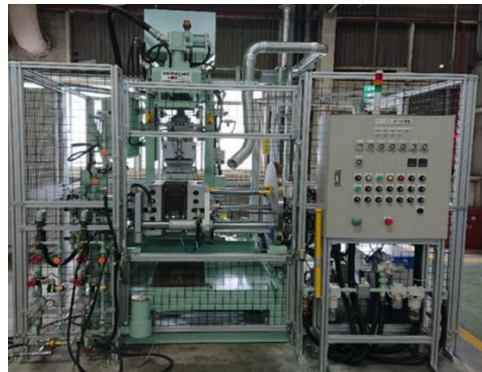
既存RCS造型設備
