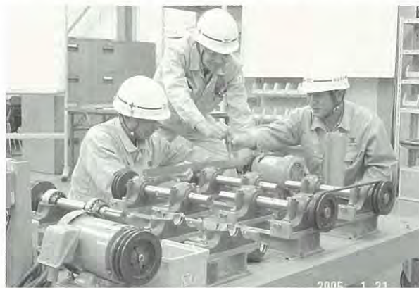
千葉工場で行われている技術伝承活動「電動式軸受装置の整備実習」
