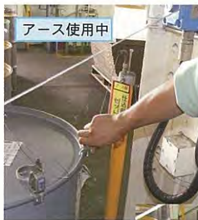
【光り物】静電気除去用アース線。使用後クリップを離すとアース線がポスト内に収納される。
