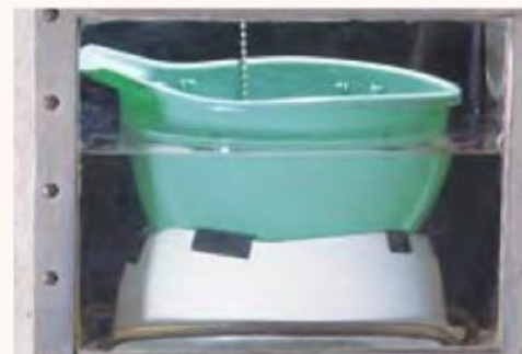
絶縁用保護具の耐電圧性能試験(電気用) (厚生労働省保護帽規格による)
