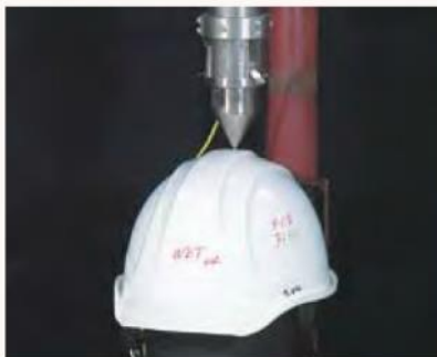
耐貫通性能試験 (厚生労働省保護帽規格による)
