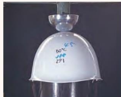
衝撃吸収性能試験 (厚生労働省保護帽規格による)
