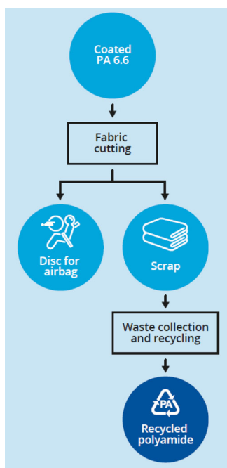
図 13：自動車用エアバックを製造するためにコーティングされたディスクのスクラップから生成された高品質のポリアミドの再生
